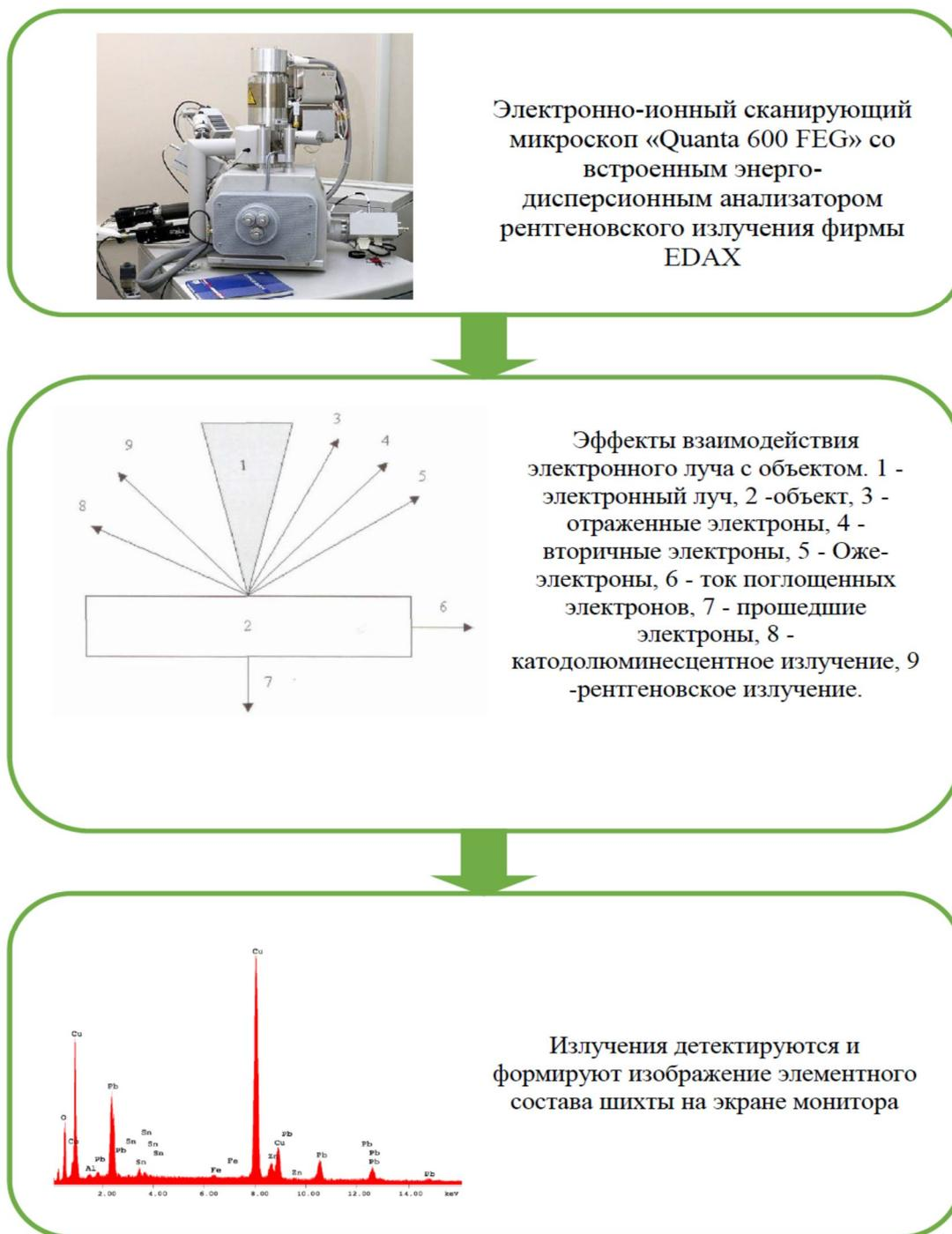
**Рис. 2.** Блок-схема методики рентгеноспектрального микроанализа сплавов
