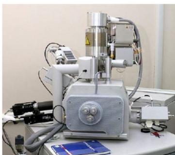
Электронно-ионный сканирующий микроскоп «Quanta 600 FEG» со встроенным энерго-дисперсионным анализатором рентгеновского излучения фирмы EDAX
