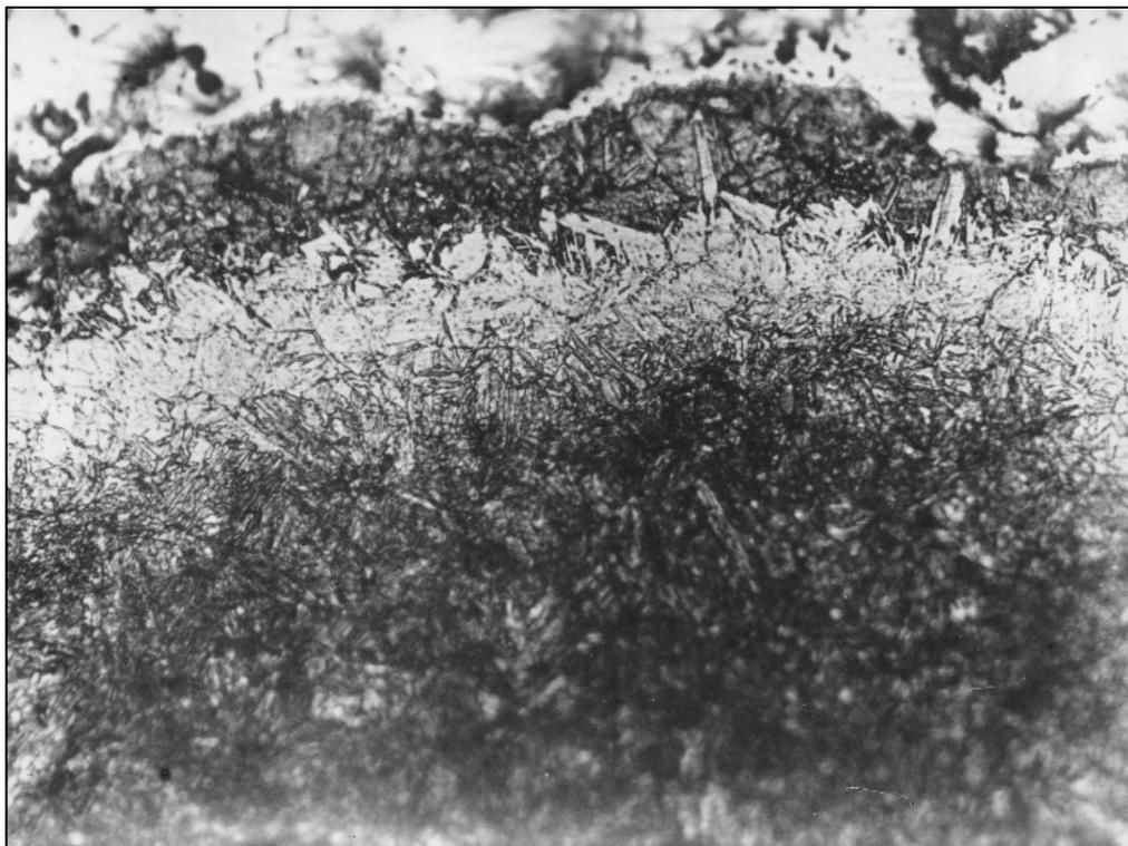
**Рис. 1.** Иглы мартенсита в стали у поверхности образца после печного отжига при температуре 1200°C в течение 6 часов,  $\times 800$
