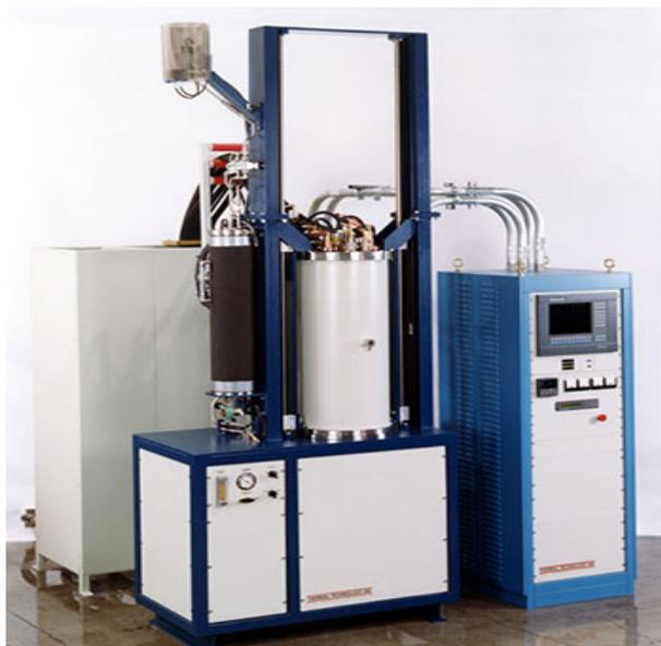
**Рис. 1.** Система искрового плазменного сплавления SPS 25-10 "Thermal Technology"
