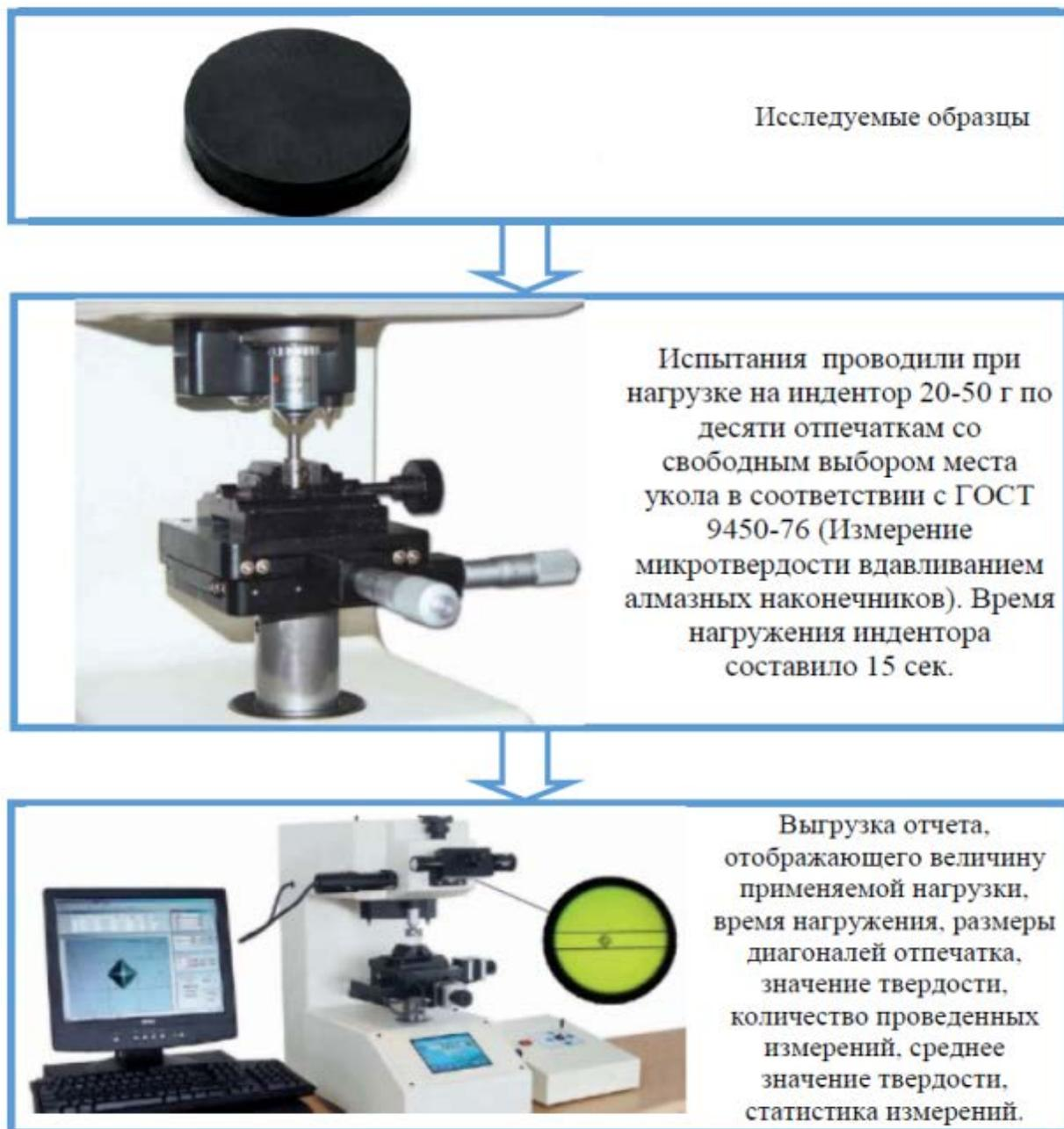
**Рис. 3.** Методика измерения микротвердости
