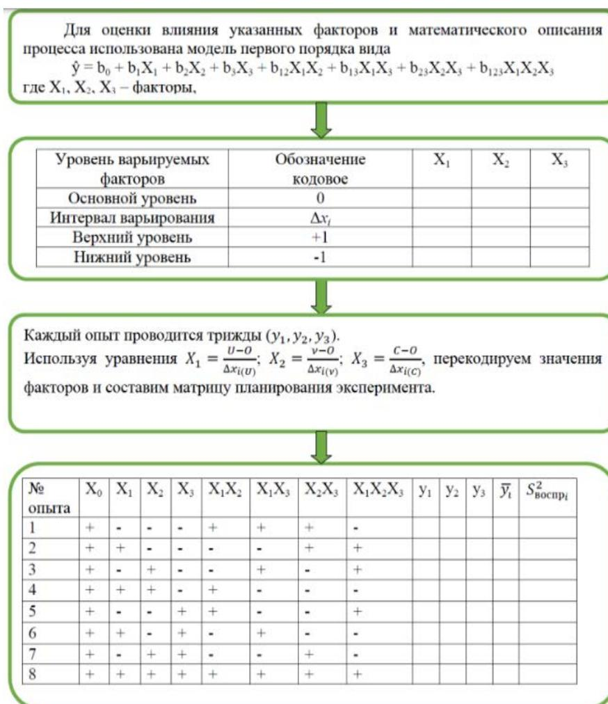
**Рис. 4.** Блок-схема методики оптимизации технологического процесса спекания нового безвольфрамового твердого сплава (этап 1)
