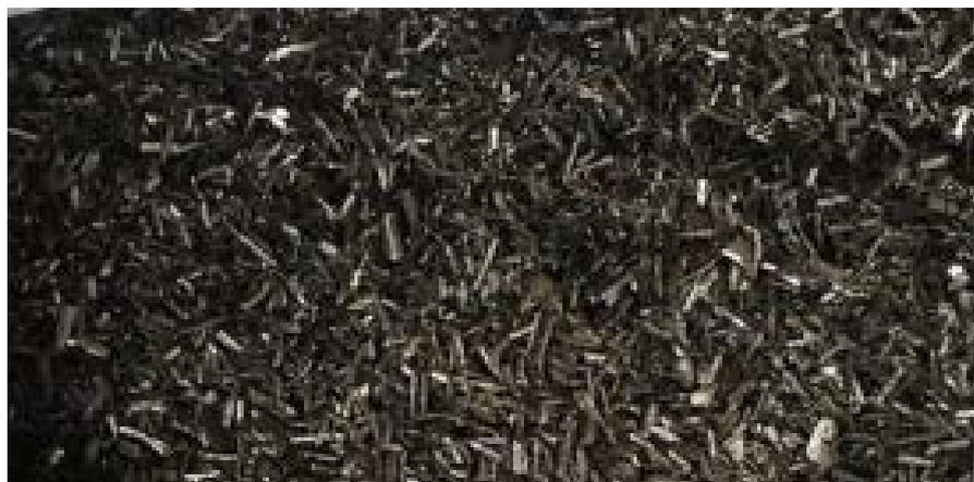
**Рис. 2.** Отходы свинцовой бронзы марки БрС30 в виде стружки
