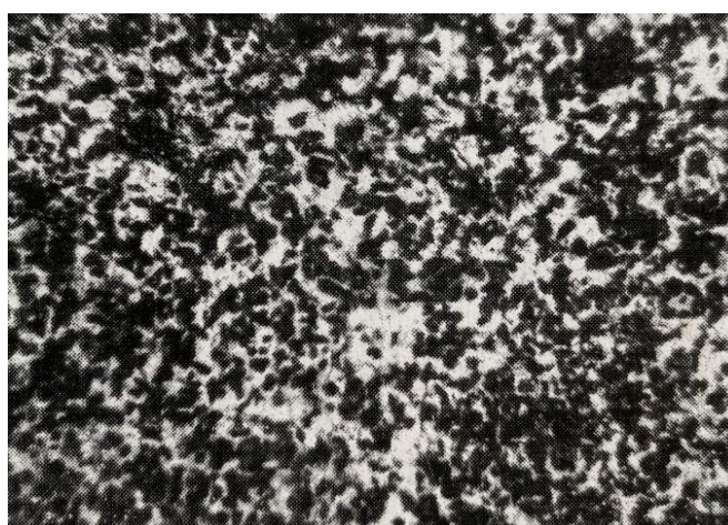
Рис. 4. Микроструктура электроосажденного железа при величине блоков мозаики 300–350 Å
