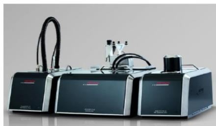
Лазерный анализатор размеров частиц «Analysette 22 NanoTec»
