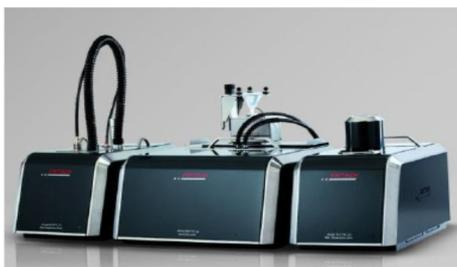
Лазерный анализатор размеров частиц «Analysette 22 NanoTec»
