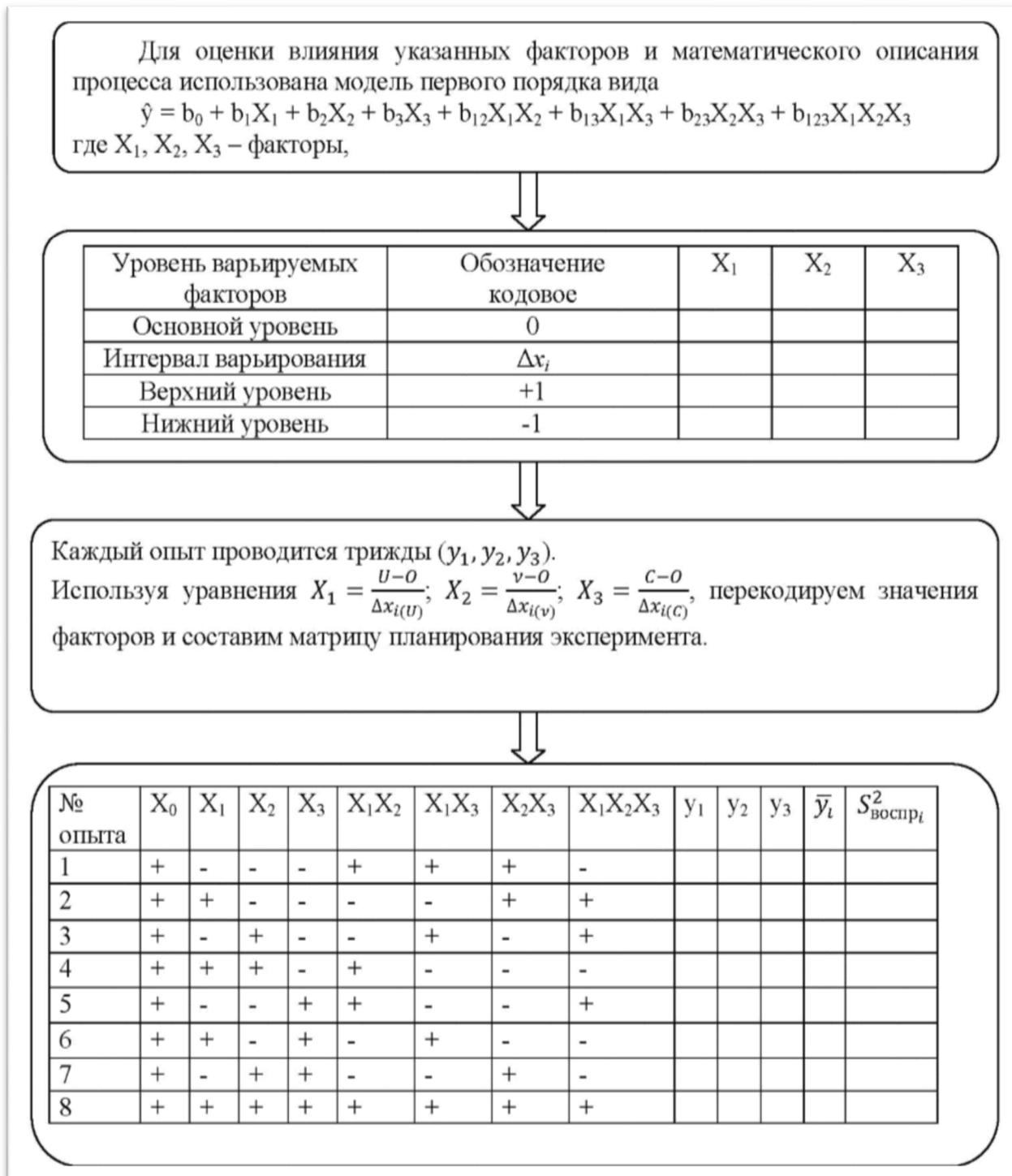
Рис. 3. Последовательность постановки полного факторного эксперимента (окончание см. на с. 78)
