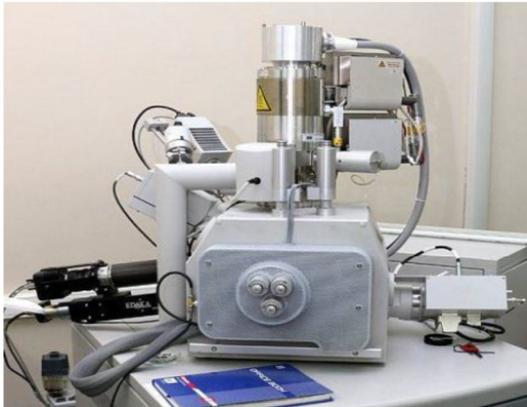
Электронно-ионный сканирующий микроскоп «Quanta 600 FEG»
