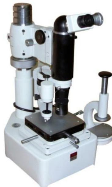
**Рис. 5.** Микротвердомер ПМТ-3М
