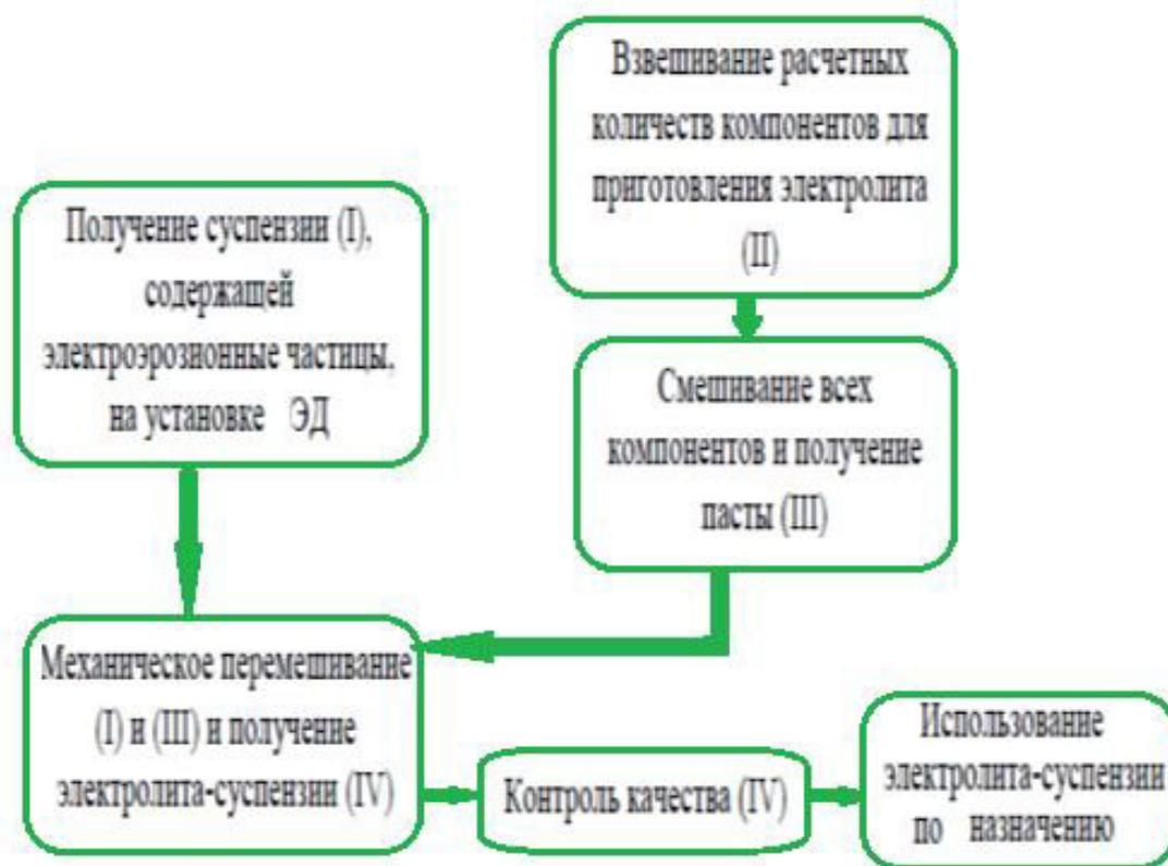
Рис. 2. Блок-схема методики приготовления электролита-суспензии
