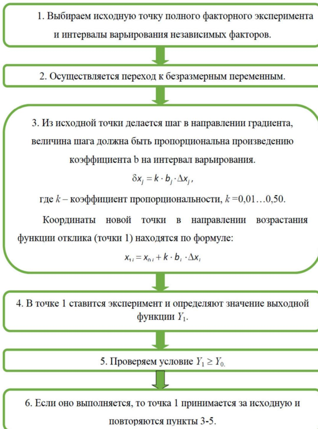
**Рис. 5.** Блок-схема методики оптимизации электроосаждения (этап 3)
