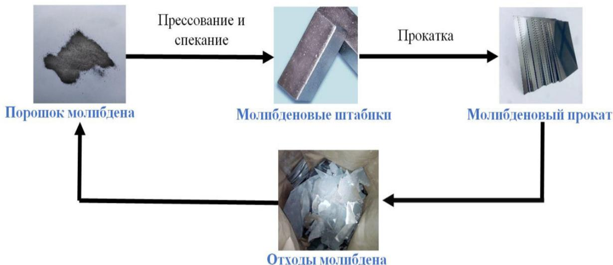
**Рис. 2.** Схема вторичного использования молибденового порошка
