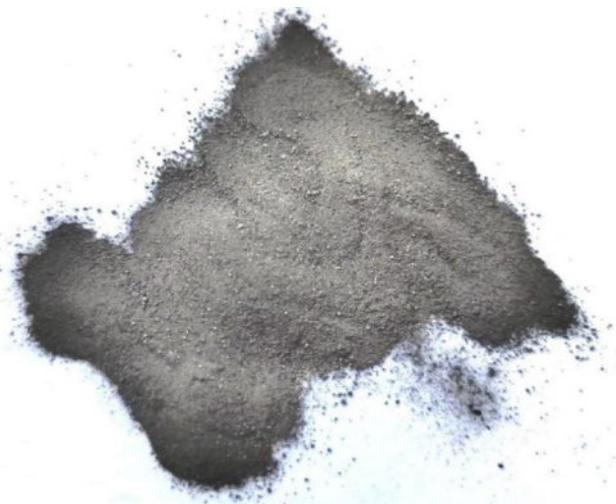
**Рис. 6.** Молибденовый электроэрозионный порошок
