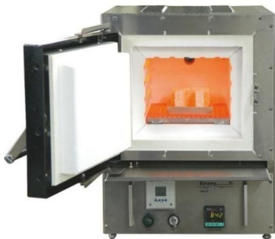
**Рис. 4.** Лабораторная муфельная печь VMK
