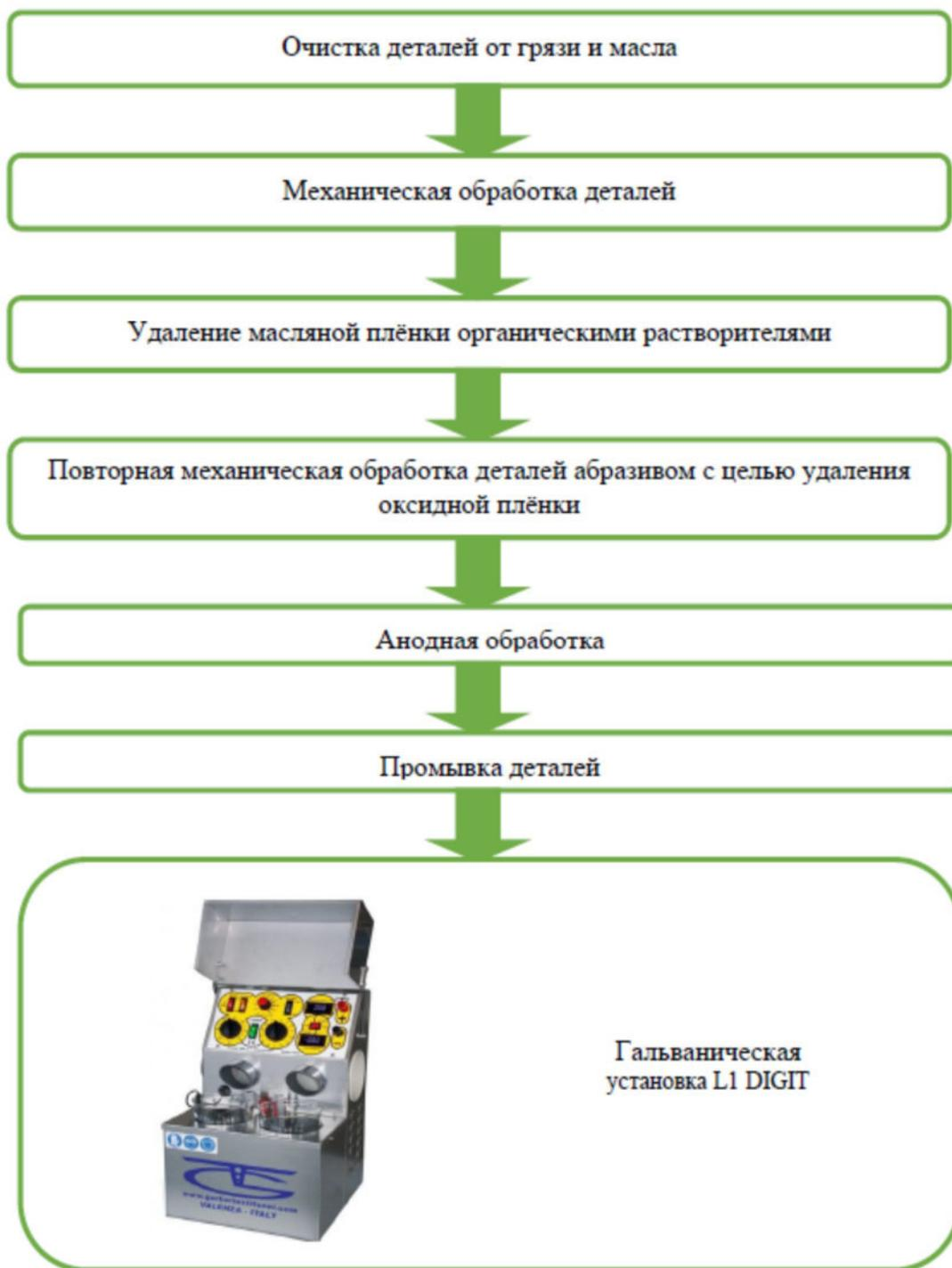
Рис. 1. Блок-схема методики электроосаждения
