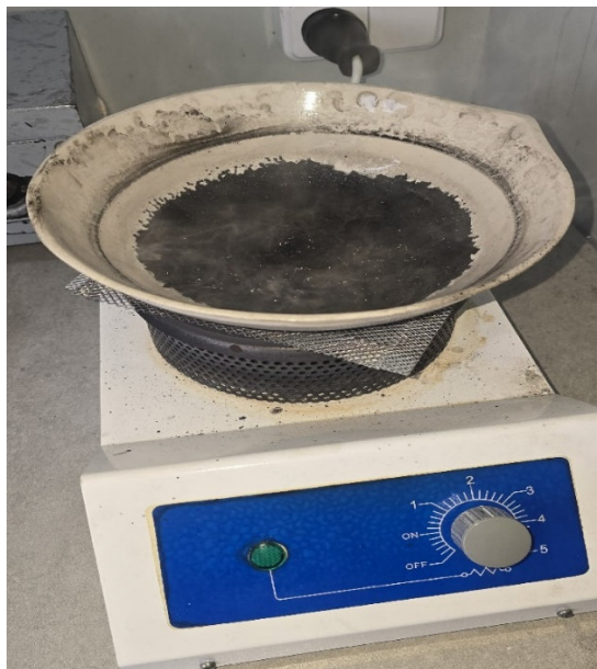
Рис. 6. Операция концентрирования дисперсного материала путём выпаривания
