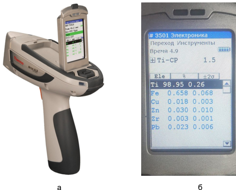
Рис. 2. Процесс измерения образца: а – используемая модель спектрометра Niton XL3t; б – отображаемые показатели элементарного состава
