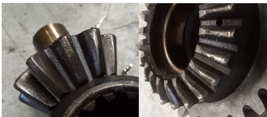
Рис. 3. Смещение пятна контакта в зацеплении шестерни и пластическая деформация зубьев шестерни полуоси
