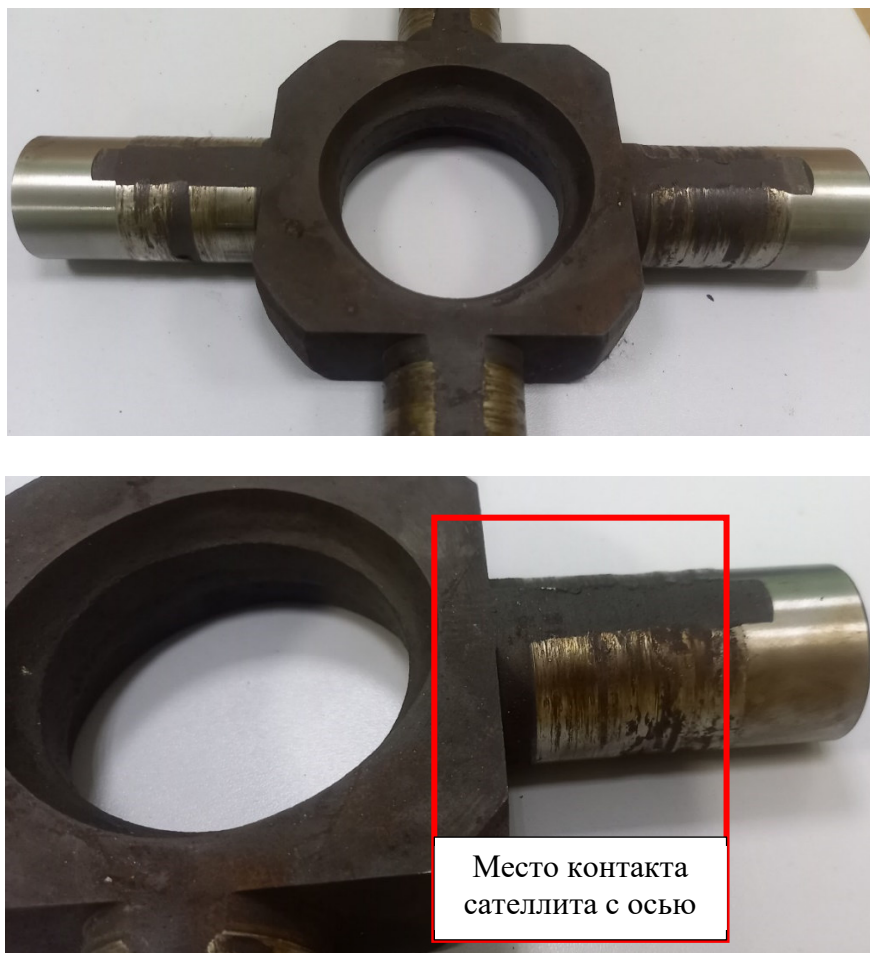
Рис. 2. Износ оси сателлитов переднего моста специального колесного шасси вследствие нарушения скоростей движения
