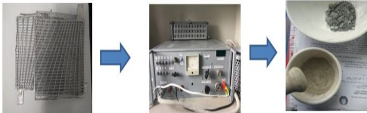
Рис. 1. Процесс получения шихты из свинцово-сурьмянистых пластин сплава марки SSu3 : а – пластины свинцово-сурьмянистой АКБ; б – общий вид установки ЭЭД; в – электроэрозионная шихта из SSu-3
