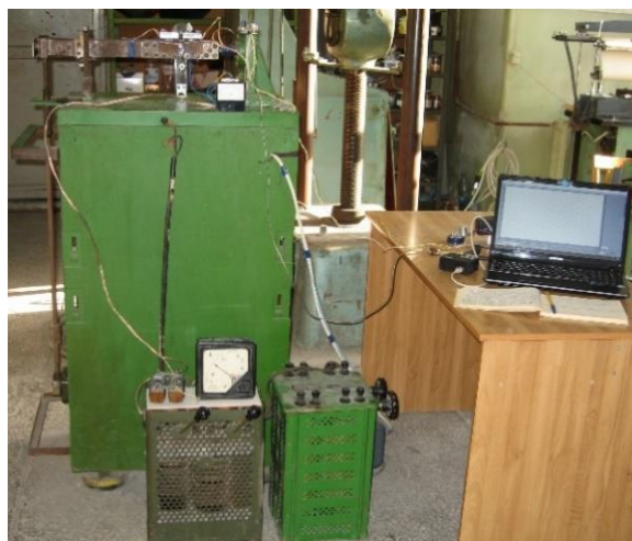
Рис. 1. Установка для усталостных испытаний на циклический изгиб
