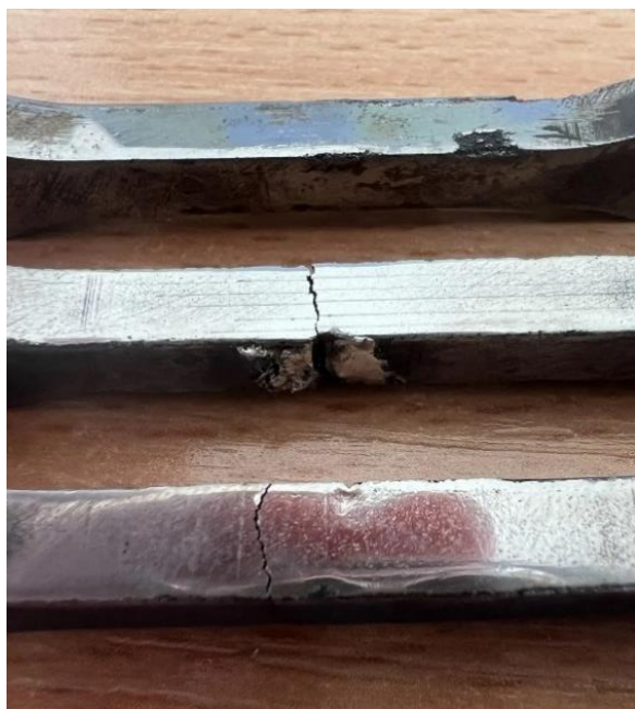
Рис. 6. Образцы до и после испытаний на усталостный изгиб
