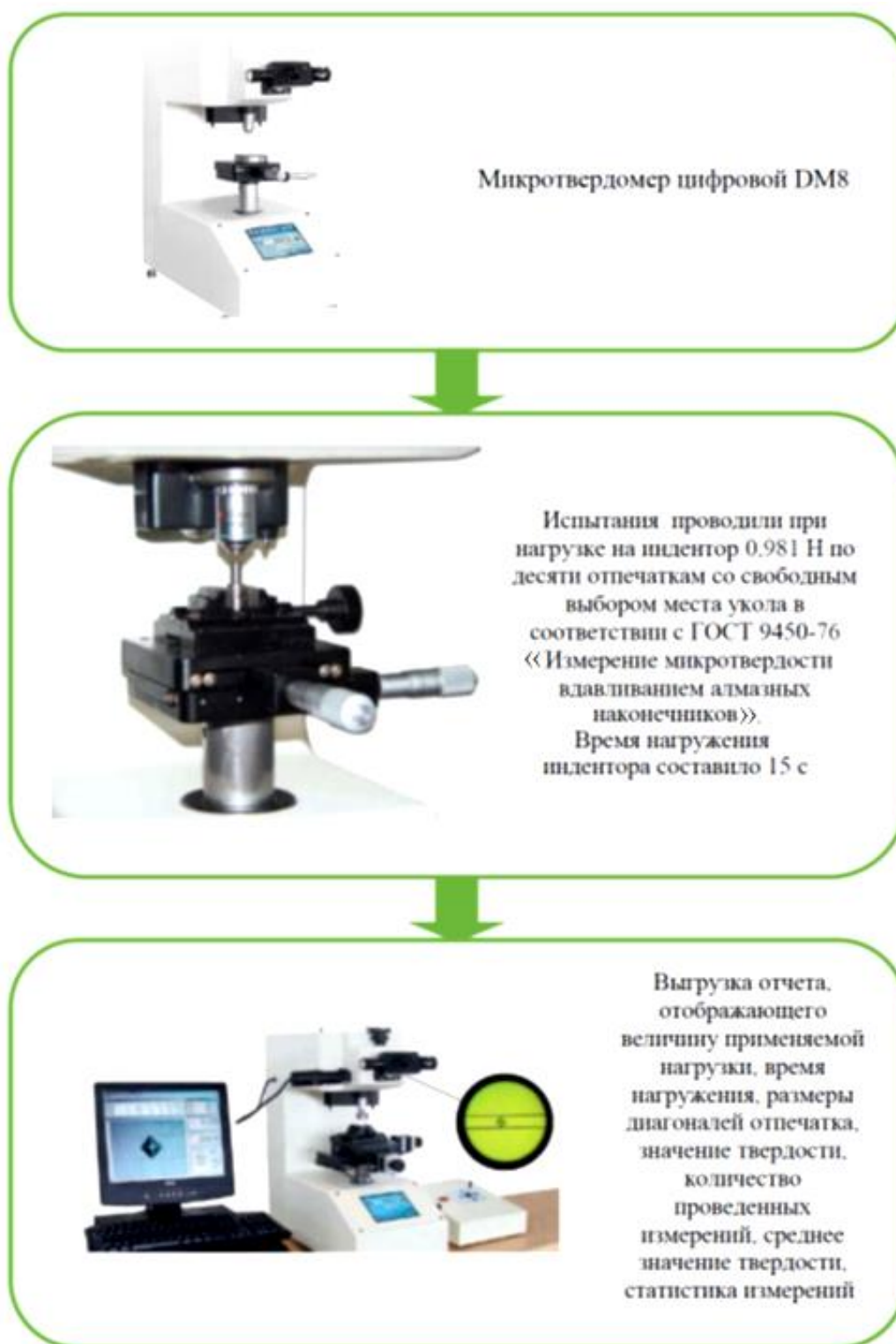
Рис. 2. Структурно-логическая схема методики исследования микротвердости аддитивного образца
