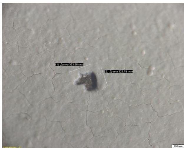
Рис. 2. Выплески материала покрытия на поверхности лопатки
