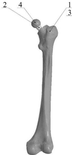
**Рис. 1.** Расчетная модель системы «эндопротез – кость»: 1 – эквидистантная оболочка, имитирующая кортикальную костную ткань; 2 – бедренный компонент; 3 – внутренняя часть бедренной кости с выработанным костномозговым каналом под бедренный компонент, имитирующая трабекулярную костную ткань; 4 – суставная головка
