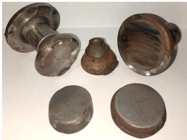
Рис. 2. Резцы КЗТС А6/20 в разрезе
