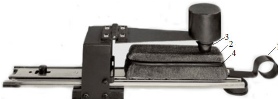
Рис. 3. Прибор для определения устойчивости огнезащитной пропитки к трению:
