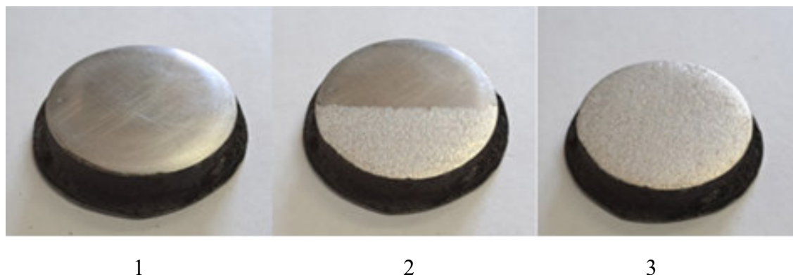
Рис. 5. Стальные цилиндрические образцы из корпуса резца дорожной фрезы КЗТС А6/20: 1 – без покрытия; 2 – с частичным покрытием; 3 – с покрытием
