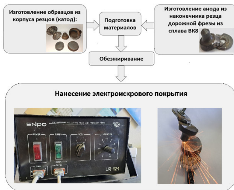
Рис. 1. Блок-схема технологии процесса нанесения электроискрового покрытия
