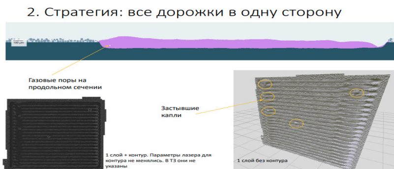
Рис. 4. Срез дорожки (трека) проплавления в последовательной стратегии
