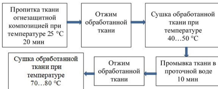
Рис. 3. Схема нанесения огнезащитной композиции на текстильные материалы
