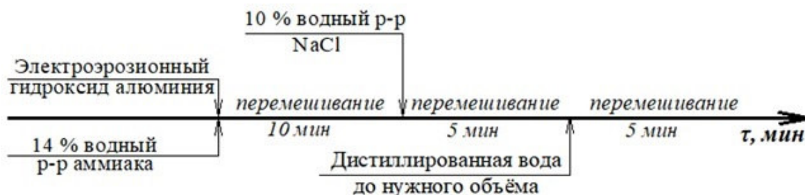
Рис. 2. Схема приготовления огнезащитной композиции
