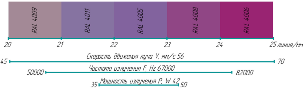
Рис. 5. График соответствия изменения параметра разрешения заливки маркируемого объекта, линия мм, с получаемым оттенком цвета по стандарту RAL
