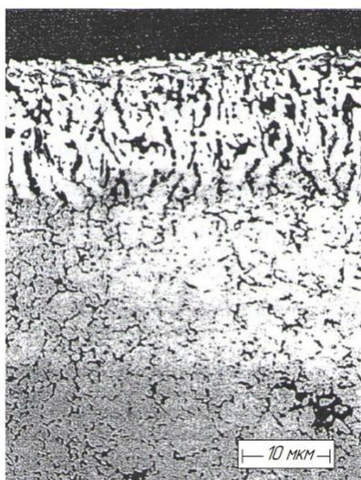
**Рис. 6.** Микроструктура поверхностного слоя стали 20X13, нитроцементованной при 950°C, 4 часа (травление реактивом Мураками – (950°C) водным раствором 10%  $K_4Fe(CN)_6$  + 10% KOH)
